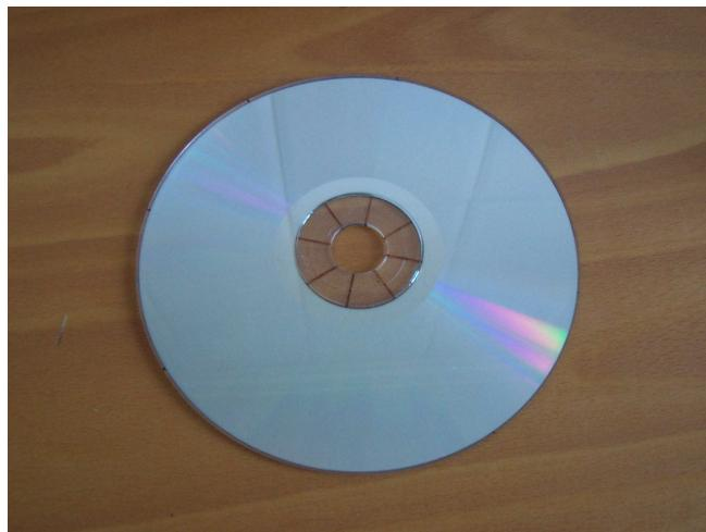
o primeiro cd serverá como base para a montaxe das pas e irá fixado con parafusos ó motor do disco duro
