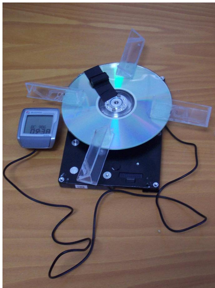
Aspecto do anemómetro xa montado co medidor
