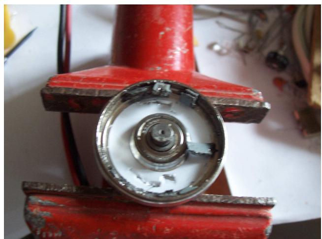
extracción dos bobinados e imán permanente
